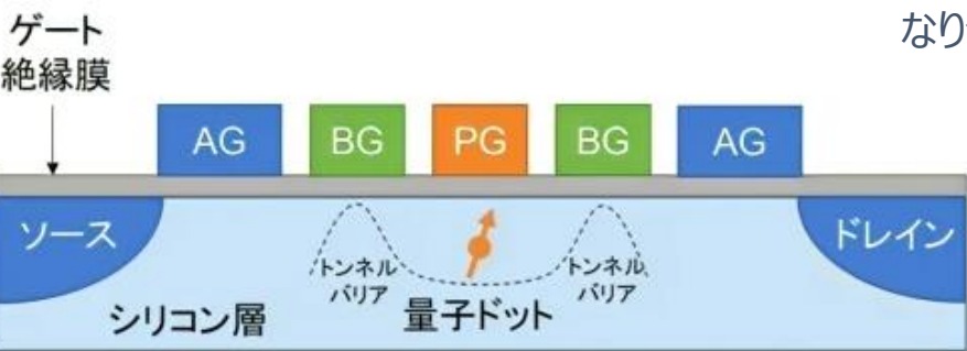
図1 産総研が試作したシリコン量子ビットの基本構造
